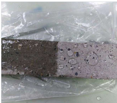
花崗石試片對照：未處理面吸水變深，處理面水珠成珠、完全不滲。
